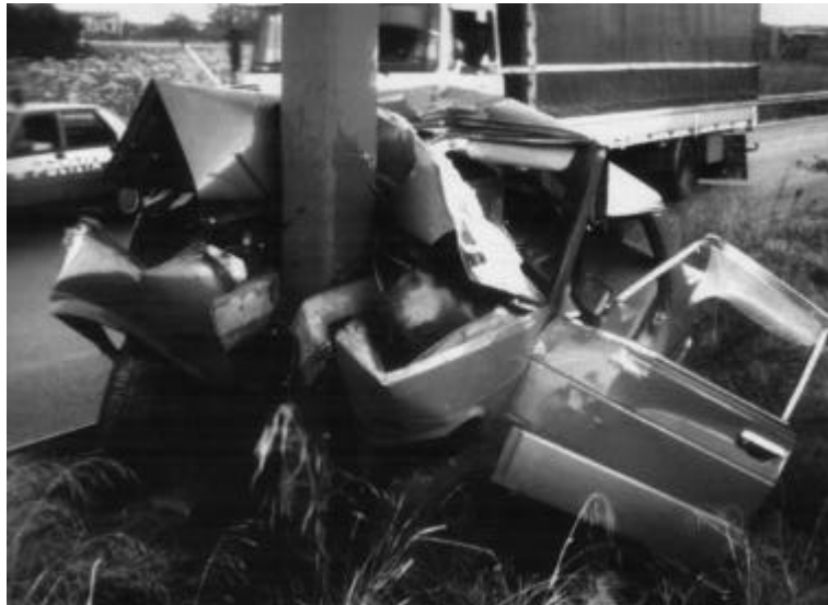
Fig. 70 Palo rigido per illuminazione non protetto.
